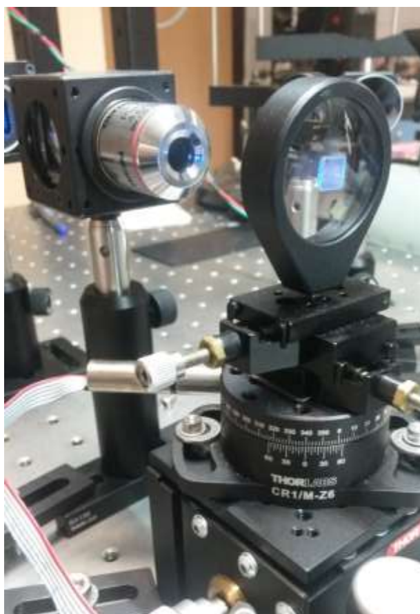
Krystal titaničitanu barnatého ve speciálním držáku s transparentními elektrodami, který je umístěn na rotačním podstavci v digitálně holografickém mikroskopu.
