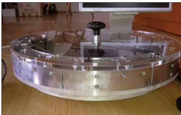
Obr. 14: Schéma a fotografie seismického senzoru Rotaфон-D
